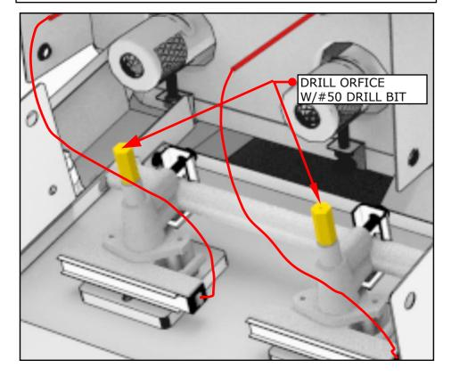
10. LIFT & ROTATE CONTROL PANEL BACK SLIDING MANIFOLD INTO PLACE
