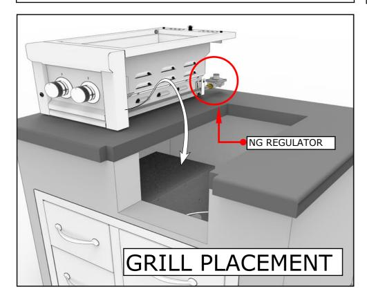
13. MAKE FINAL GAS LINE CONNECTION BEFORE SLIDING GRILL IN PLACE.
